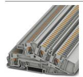
Installationsetagenklemme, Push-in-Anschluss, Querschnitt: 0,2 mm² - 6 mm², AWG: 24 - 10, Breite: 6,2 mm, Farbe: grau, Montageart: NS 35/7,5, NS 35/15
