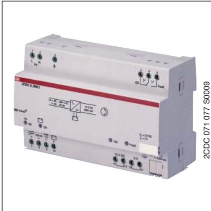
Das Unterbrechungsfreie Netzteil NTU/S 12.2000.1 ist ein modulares Installationsgerät im ProM-Design zum Aufschnappen auf eine 35-mm-Tragschiene in Universal-, Wand- oder Deckenverteilern sowie in dezentralen Aufputzgehäusen. Mit einer gepufferten Ausgangsspannung von 12 V DC und einem maximalen Ausgangsstrom von 2 A bietet das Netzteil genügend Leistung für anspruchsvolle Anwendungen aller Art.
