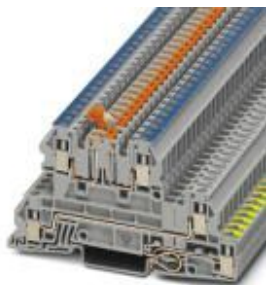
Installationsschutzleiterklemme, Schraubanschluss, Querschnitt: 0,2 mm 2 - 4 mm 2 , AWG: 24 - 12, Breite: 5,2 mm, Farbe: grau, Montageart: NS 35/7,5, NS 35/15
