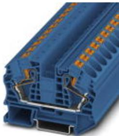
Durchgangsklemme, Nennspannung: 1000 V, Nennstrom: 76 A, Anschlussart: Push-in-Anschluss, Anzahl der Anschlüsse: 2, Querschnitt: 0,5 mm<sup>2</sup> - 25 mm<sup>2</sup>, AWG: 20 - 4, Breite: 12,2 mm, Farbe: blau, Montageart: NS 35/7,5, NS 35/15
