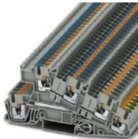
Installationsschutzleiterklemme, Push-in-Anschluss, Querschnitt: 0,14 mm<sup>2</sup> - 4 mm<sup>2</sup>, AWG: 26 - 12, Breite: 5,2 mm, Farbe: grau, Montageart: NS 35/7,5, NS 35/15
