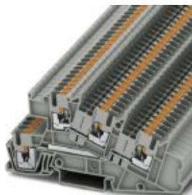
Installationsetagenklemme, Push-in-Anschluss, Querschnitt: 0,14 mm<sup>2</sup> - 4 mm<sup>2</sup>, AWG: 26 - 12, Breite: 5,2 mm, Farbe: grau, Montageart: NS 35/7,5, NS 35/15
