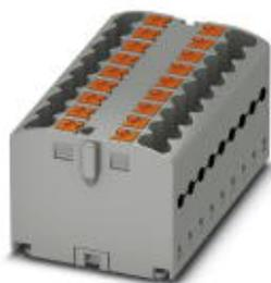
Verteilerblock, Grundklemme, Nennspannung: 500 V, Nennstrom: 24 A, Anschlussart: Push-in-Anschluss, Anzahl der Anschlüsse: 18, Querschnitt: 0,14 mm<sup>2</sup> - 4 mm<sup>2</sup>, AWG: 26 - 12, Breite: 46,5 mm, Höhe: 21,2 mm, Farbe: grau, Montageart: aufrasten auf Tragschienenadapter, Adapterplatte
