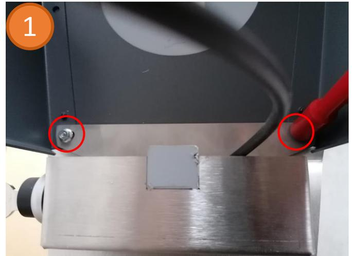
Der Schlüsselschalter wird fertig montiert in einem Edelstahlgehäuse geliefert und ermöglicht es die Wallbox gegen unberechtigtes Laden zu sichern.
