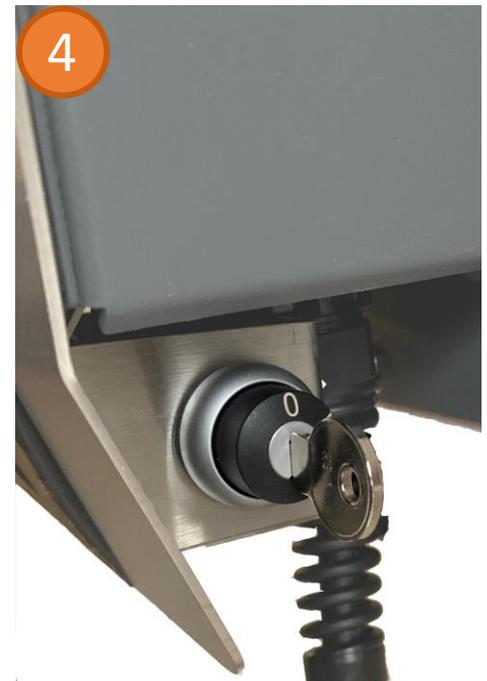
Das Kabel durch die vorhandene Multieinführung (Energy Control), bzw. durch die Membrane (Home Eco) auf der Unterseite in die Anschlussbox einführen.
